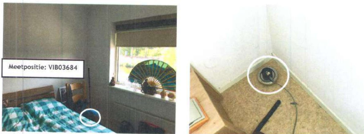
Afb. II: Meetpositie conform SBR- B: Hinder voor personen | 1 ste verdieping- voorzijde | Gooilandlaan 51 te Heerenveen
