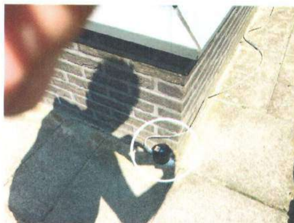
Afb. II: Meetpositie conform SBR- A: Schade aan gebouwen | Voorgevel- Gooilandlaan 51 te Heerenveen
