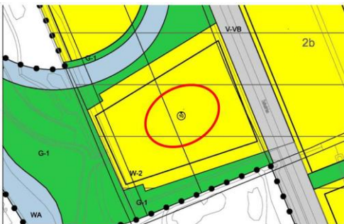
Afbeelding 4: opnemen maatvoering binnen bouwvlak: maximum bouwhoogte (10 meter)
