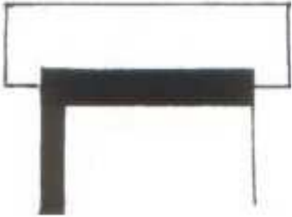
Schematische tekening van een latei
