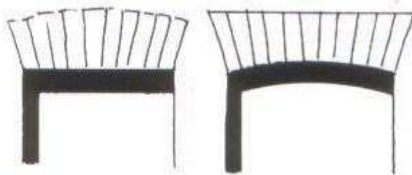
Links de gestreckte toog, rechts de getoogde strek.
