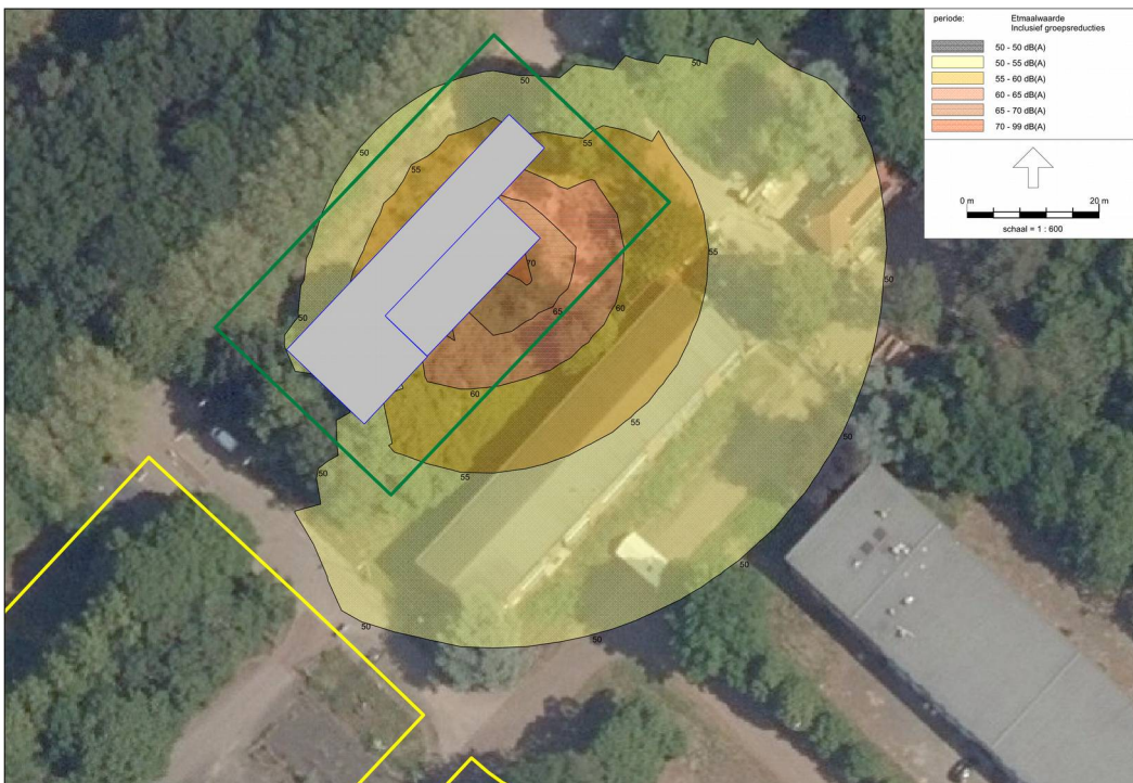
f3.3 Berekende etmaalwaardecontouren, incl. toeslag, TR2+3 vollast dag/avond en 75% nacht, TR1 nullast
