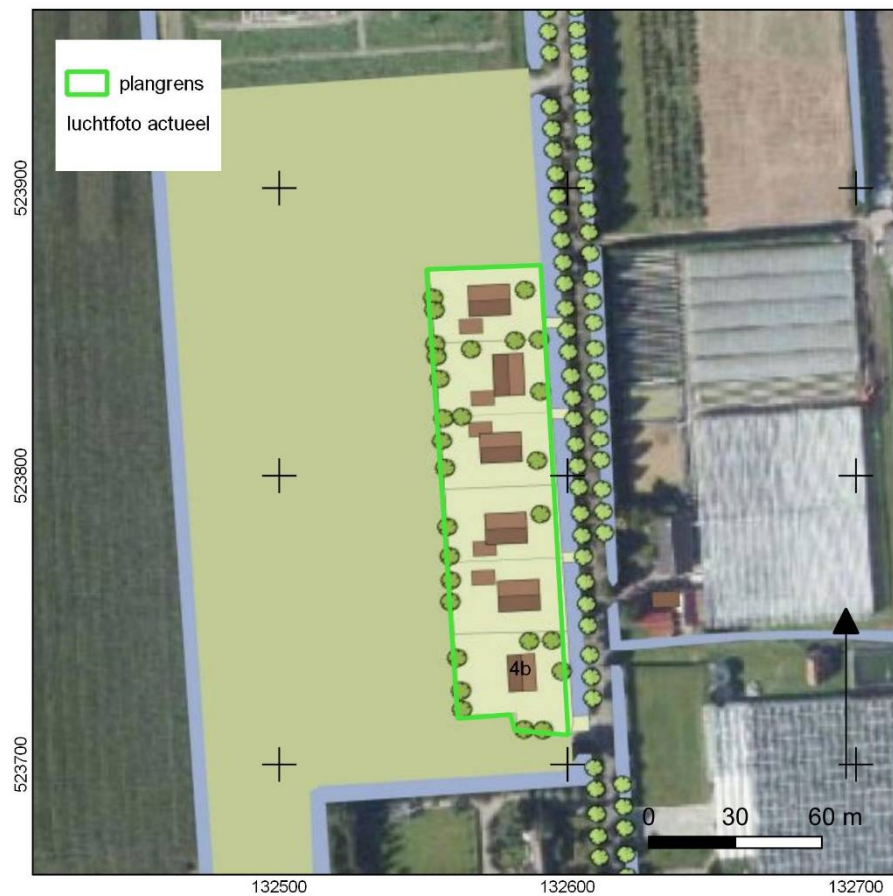
Afbeelding 3. Ontwerptekening nieuwe situatie. De kassen worden gesloopt, maar de woning op adres Ganker 4b blijft gehandhaafd.
