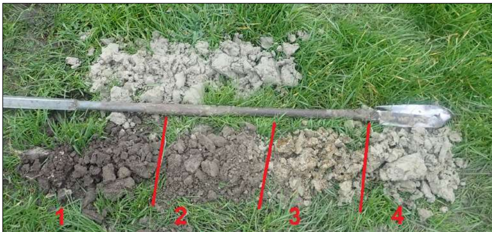
Afbeelding 15. Foto van boring 10, waarbij 1: bouwvoor, 2 vergraven zeeklei vermengd met kwelderazettingen, 3: sterk zandige klei met roest- en mangaan vlekken (kwelder), 5: zand (kwelderwal)
