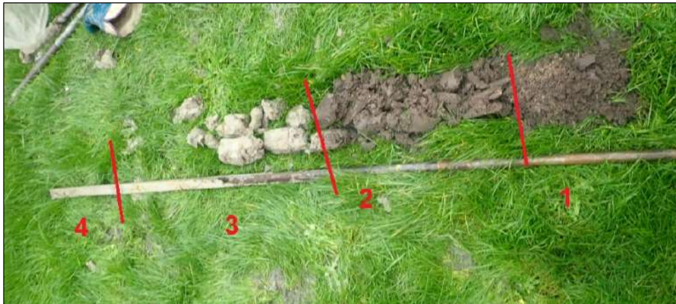
Afbeelding 14. Foto van boring 1, waarbij 1: bouwvoor, 2: vergraven zeeklei aan de basis vermengd met kwelderazettingen, 3: kwelderazetting met zandbanden, 4: wadafzetting
