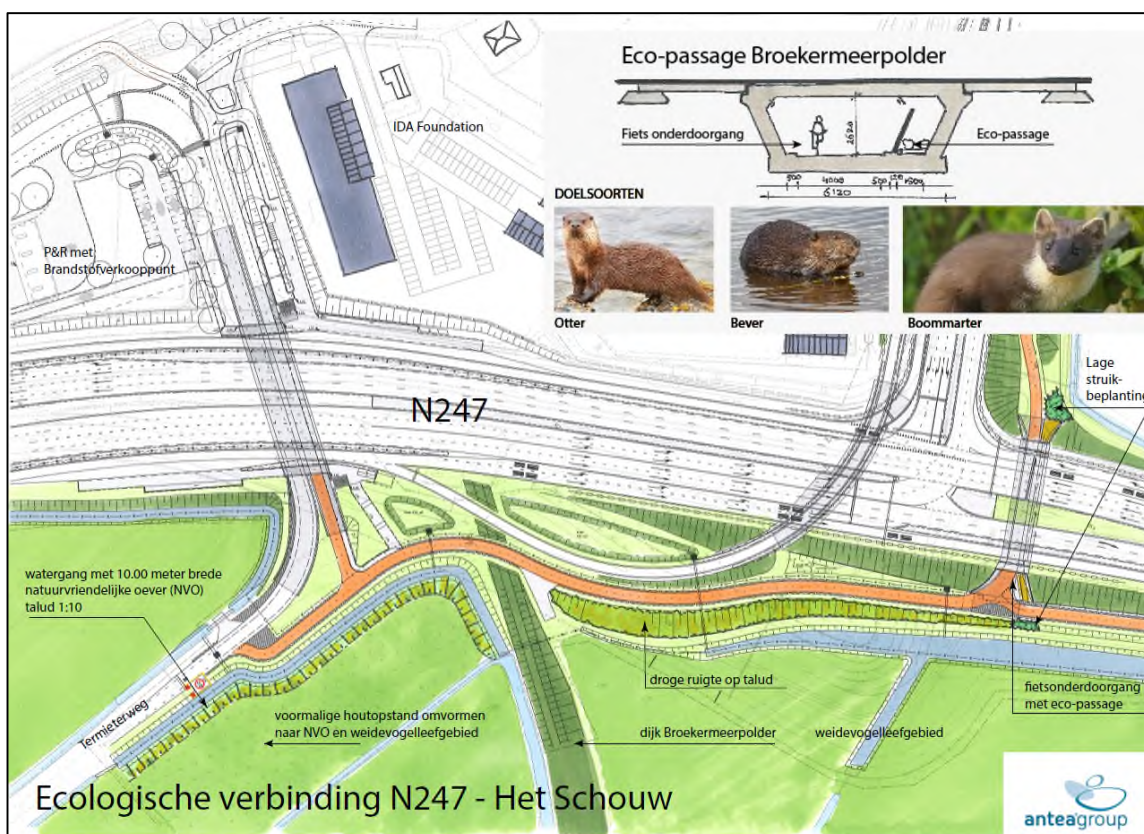
Figuur 7 Ecologische verbinding tussen onderdoorgang Het Schouw en het voormalig populierenbos
