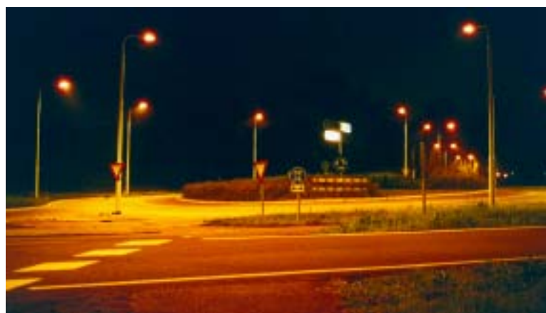
Hoge druk Natrium. Goed te richten, weinig vervuulende componenten.
