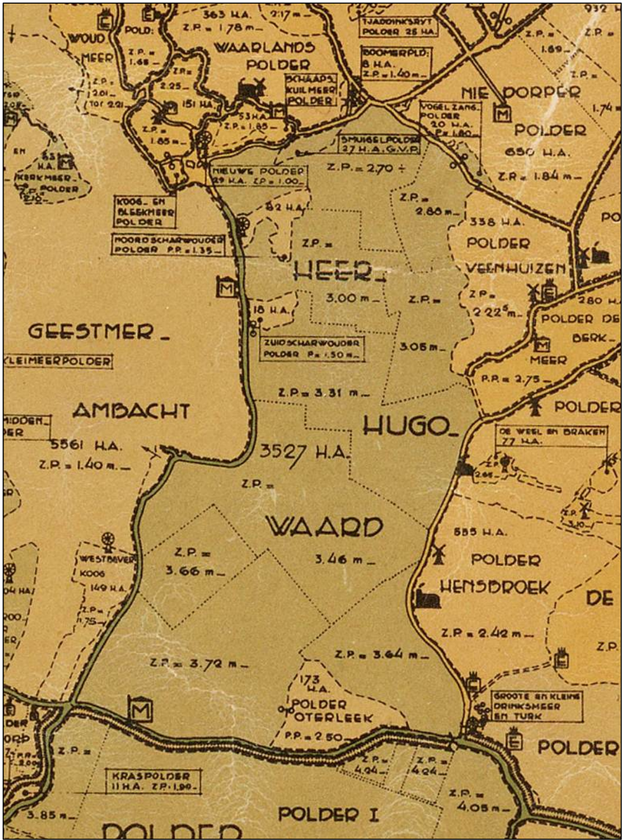
Afb. 27: De kaartbijlage bij de derde druk van De zeweringen en waterschappen van Noordholland van D. Kooiman uit 1936 laat de onderpolders van de polder Heerhugowaard zien met een schaal van 1:100.000. De kaart geeft per polder aan wat het zomerpeil ten opzichte van NAP in die tijd was. De grenzen van de onderpolders liepen gedeeltelijk gelijk met de oude gemeentegrenzen.
