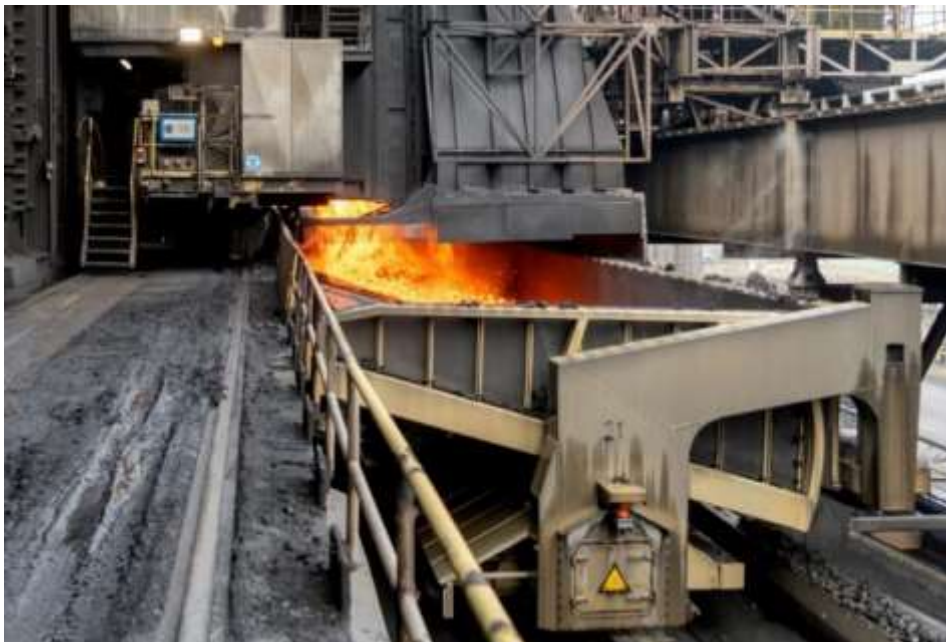
Figuur 4.9 Kooks die uit de kookskamers worden gedrukt in een bluswagen (bron: Tata Steel)
