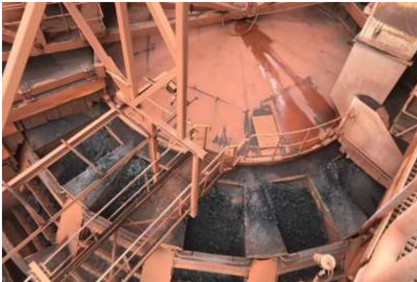
Figuur 4.7 Een sinterkoeler (bron: Tata Steel)
