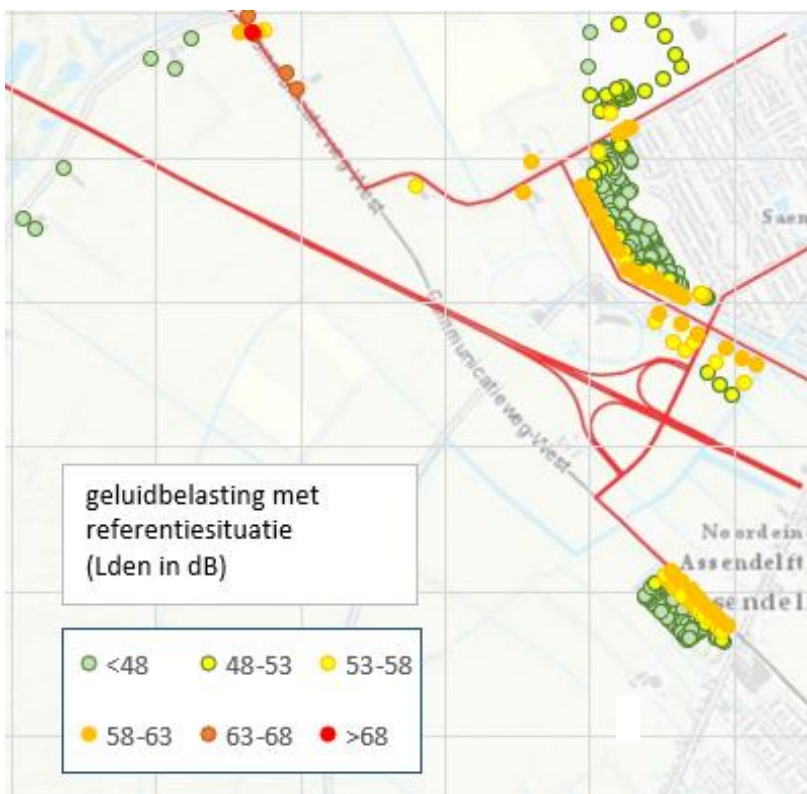
Figuur 6: Geluidbelasting in de referentiesituatie (zonder Verbinding A8-A9)
