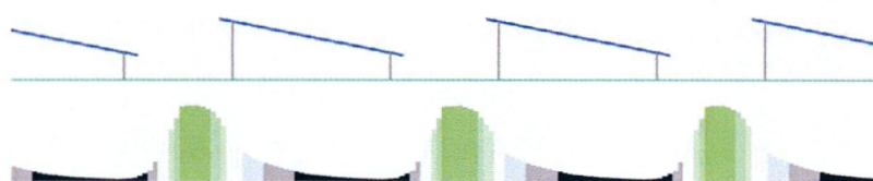
Figuur 1: zuid-opstelling zonnepanelen en lichtinval op ondergrond 1
