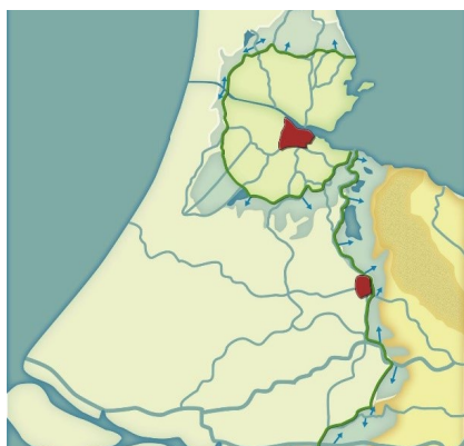
Stelsel van sluizen en watergangen voor inundatie van het 'onveilige' buitengebied.
