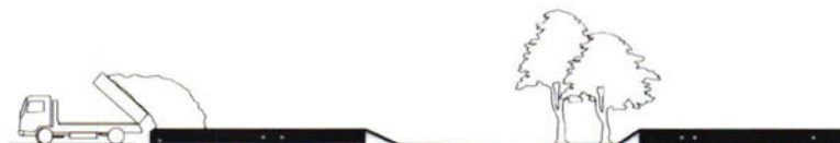
Bepaalde ophoging bouwvelden enkel ten behoeve van infrastructuur, kabels en leidingen en bebouwing. Groen en water op oorspronkelijk peil.
