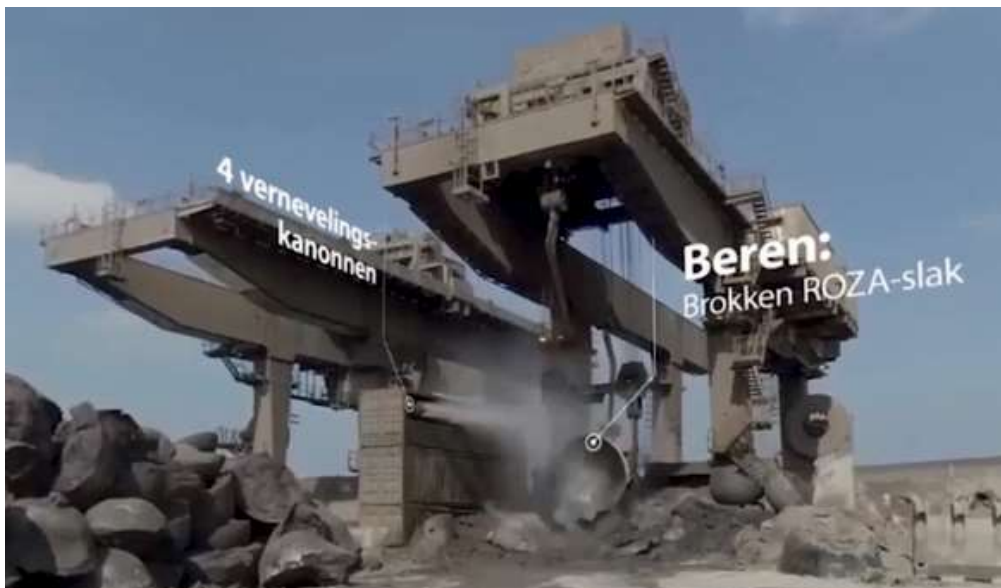
Figuur 4.3 Kiepen van ROZA-slak (bron: Tata Steel)
