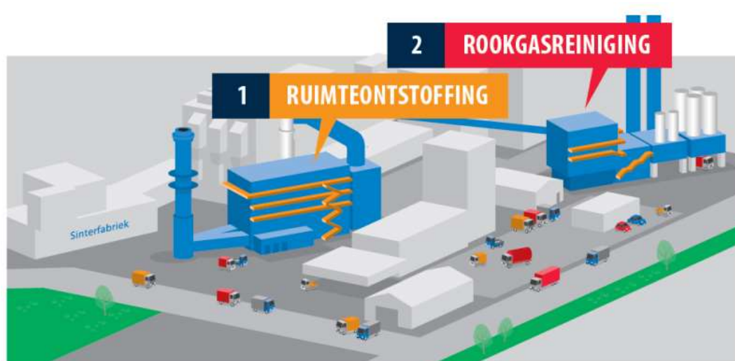
Figuur 4.1 De Doekfilterinstallatie bestaat uit twee onderdelen: de ruimteontstopping en de rookgasreiniging 127
