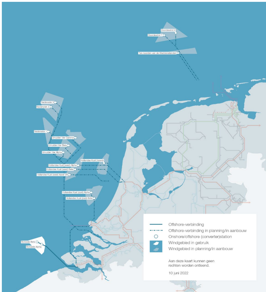
Figuur 2.1 TenneT legt de transportverbindingen aan voor de Windparken op de Noordzee
