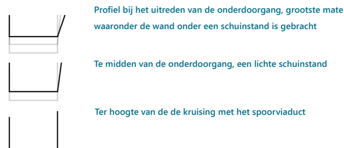
Afbeelding 5.3 Principeprofiel geluidsscherm langs de Rijksweg Noord
