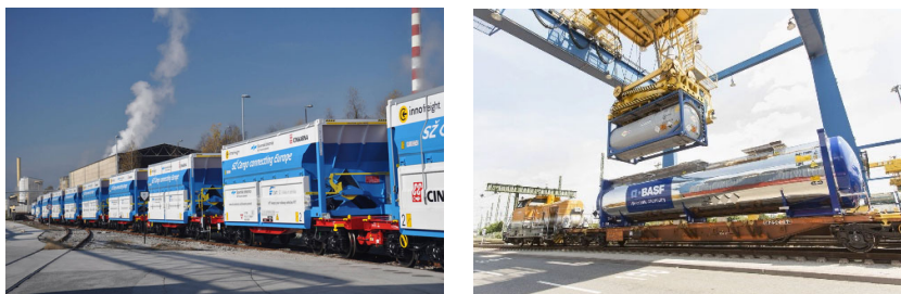
Figuur 4.5: Nieuwe ladingconcepten van inno freight en BASF voor bulkgoederen. Steeds meer producten zijn per container te vervoeren en over te slaan
