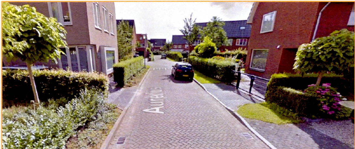
Fig. 2. Beeld van de Aurelius. Opvallend is het smalle straatbeeld (ca 6,5m tussen de gevels) en het ontbreken van een trottoir, zodat over straat gelopen wordt. Ook bijzonder is dat de linker uitritten (zuidzijde) vrijwel direct op de rijbaan uitkomen.
