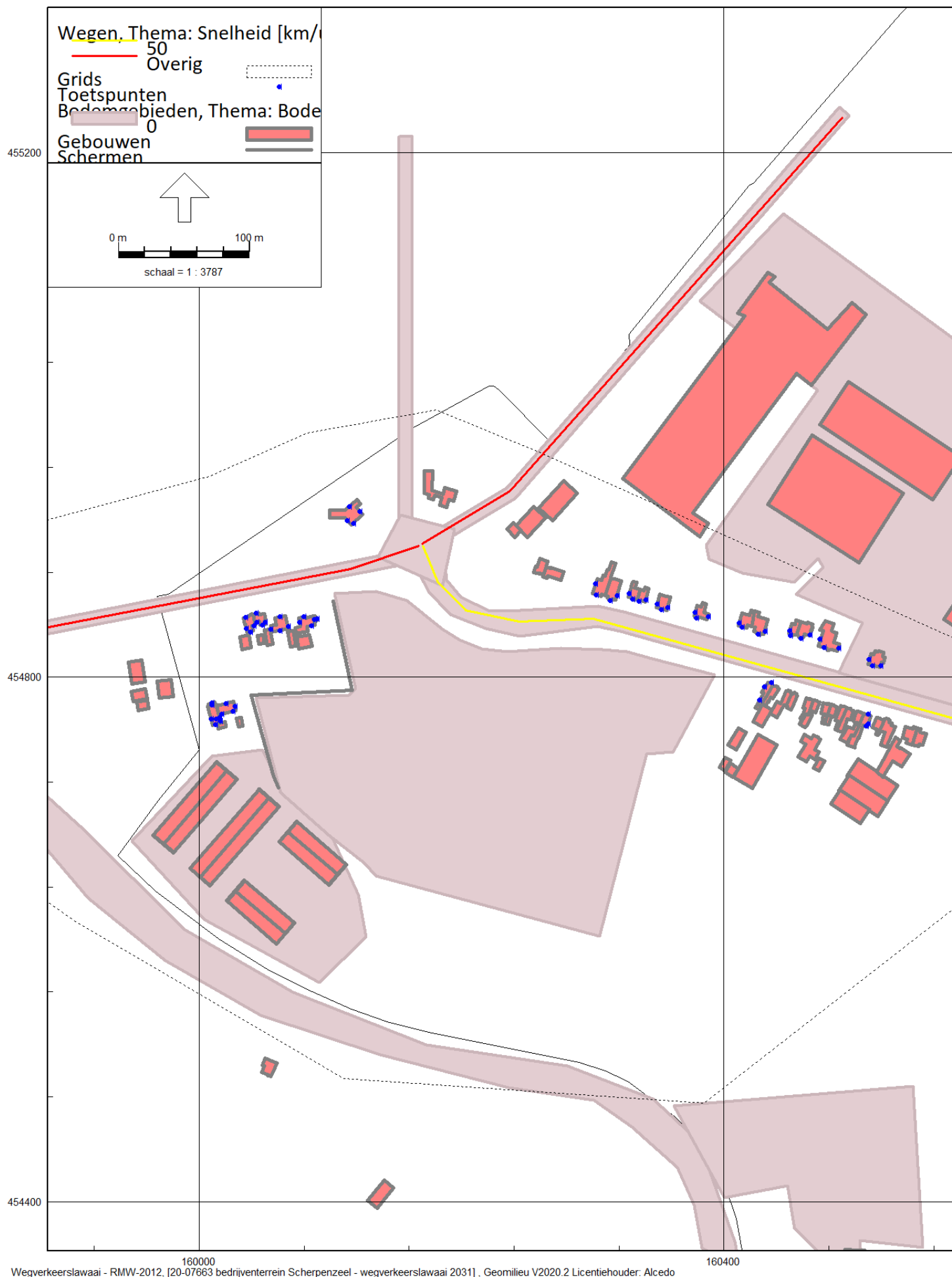
Figuur 5 | Overzicht rekenmodel wegverkeerslawaaai
