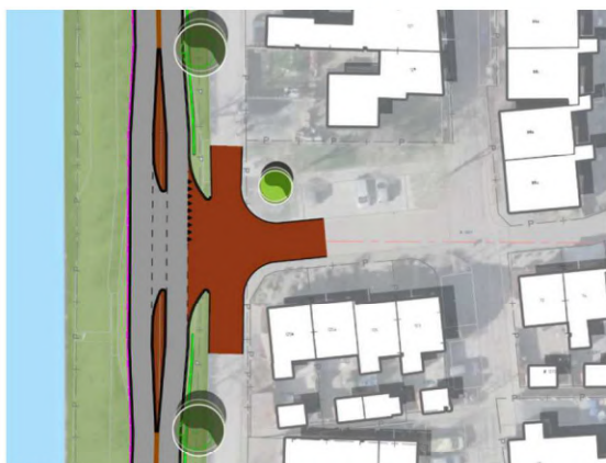
Afbeelding: aansluiting zijweg met kruisingsvlak parallelweg, verharding middengeleiders en rijbaanscheiding in dezelfde kleur klinkerverharding
