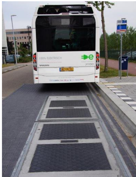
Figuur 2 – Proef met inductief laden van elektrische in Den Bosch (foto: Bluekens Volvo)
