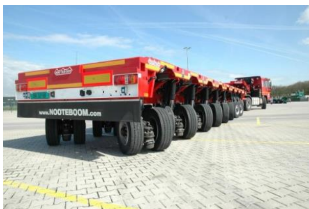
Figuur 3: Detail werking pendelassen
