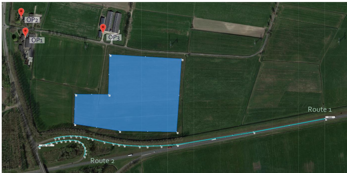
Figuur 4.1: Ingetekende zonnepark (transparant blauwe vlak) met daarbij de twee routes waarvoor de reflectie berekend wordt en de observatiepunten voor de omwonenden.
