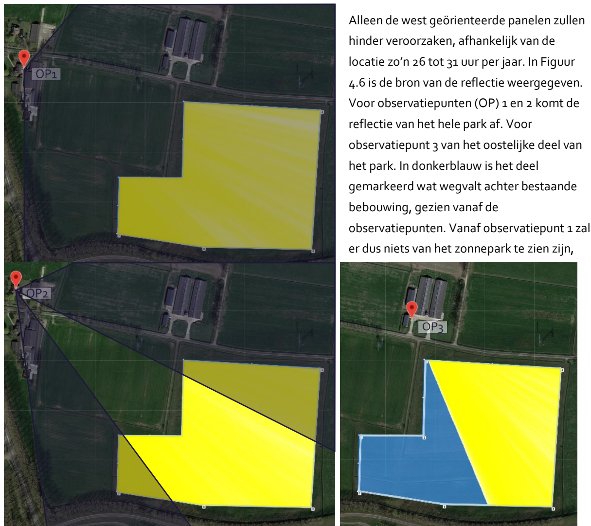
Figuur 4.6: Schitterende delen van de zonnepanelen, zichtbaar vanaf de drie observatiepunten. Hoe gele de kleur, hoe meer reflectie.
