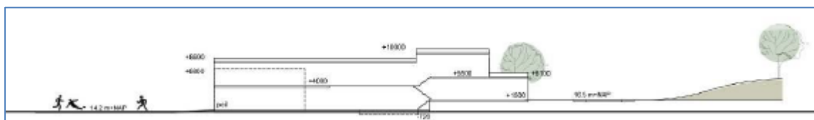
Doorsnede bouwmassa met gebruik van split-level
