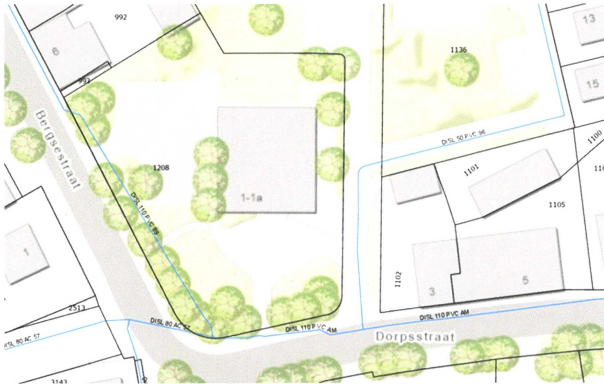
Waterleidingen aan de Dorpsstraat, Bergsestraat te Huijbergen
