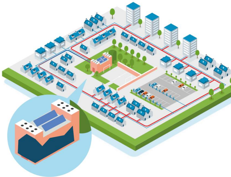
Figuur 6.9.1.1: Collectief Lucht/waterwarmtepompsysteem in een energiehuis (bron: Qirion/Alliander)
