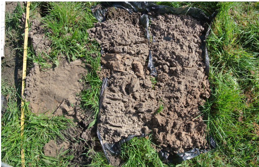
Fig. 8. De boringen werden op een vuilniszak uitgelegd. Hier zijn de eerste lagen zichtbaar uit de eerste boring (opgehoogd zand).
