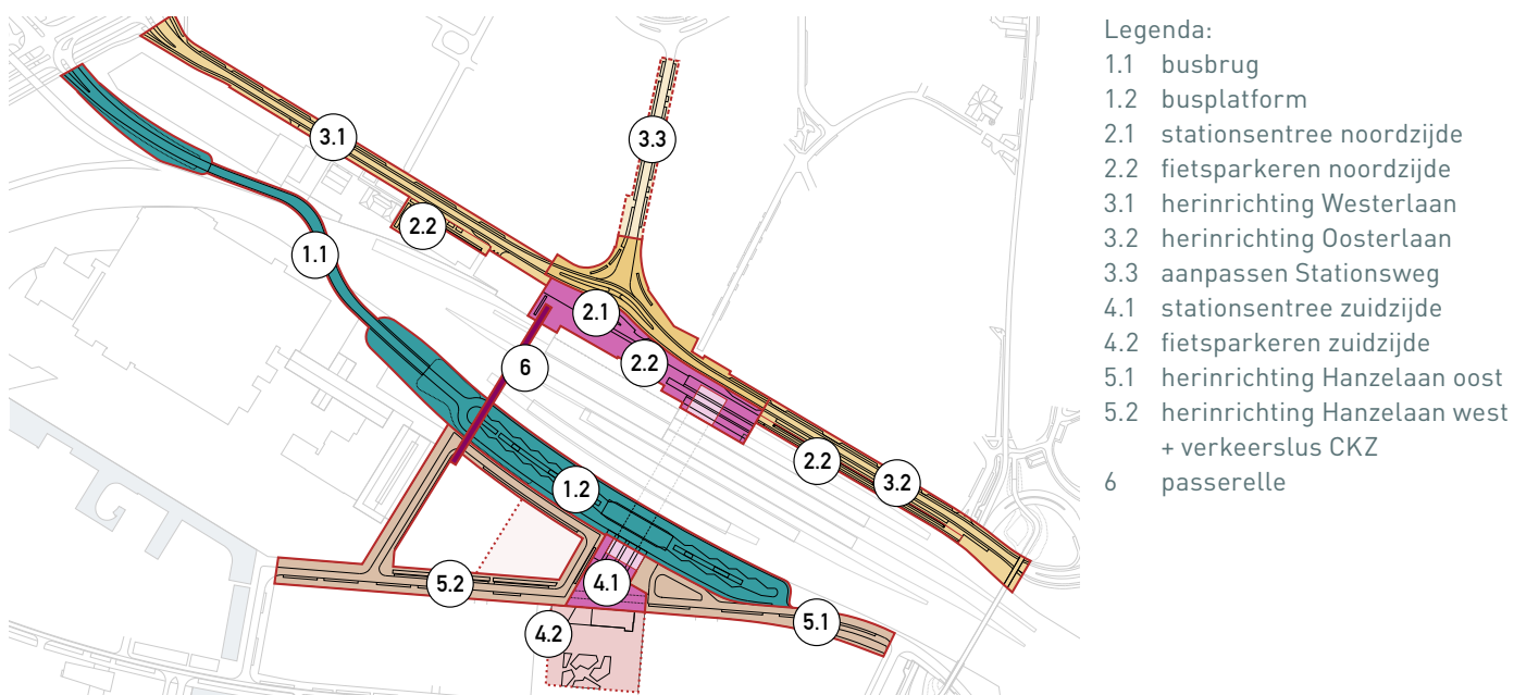
afb.04 Doorwerken aan de planelementen uit het Investeringsbesluit
